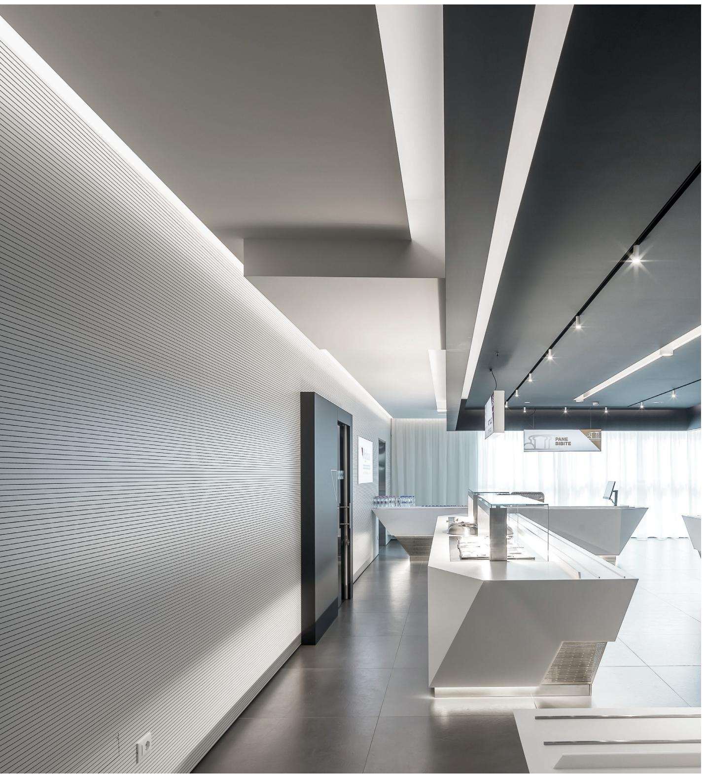
Profilo in alluminio concepito per essere installato in modo strutturale nelle intersezioni tra parete e soffitto. Particolamente adatto per creare segni luminosi lungo le pareti o in generale ad angolo.
